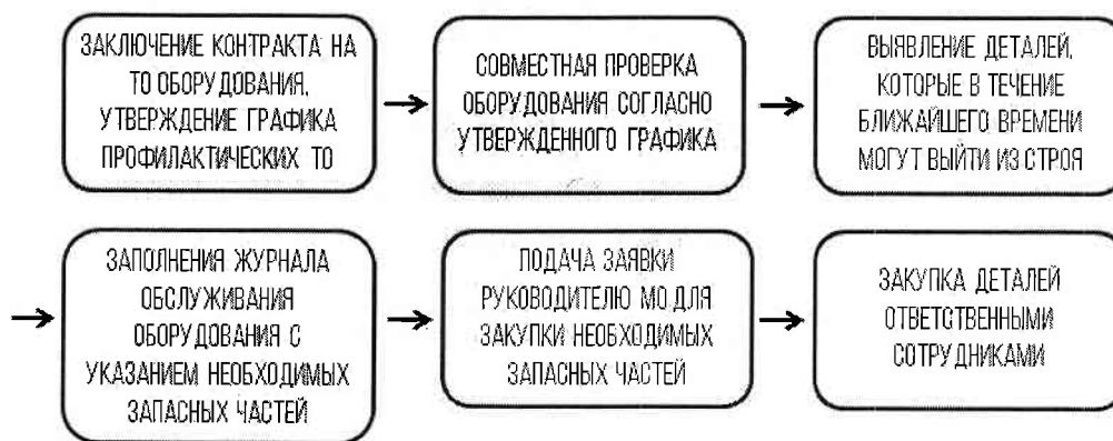
Рис. 38— Алгоритм плановой работы по обслуживанию оборудования
